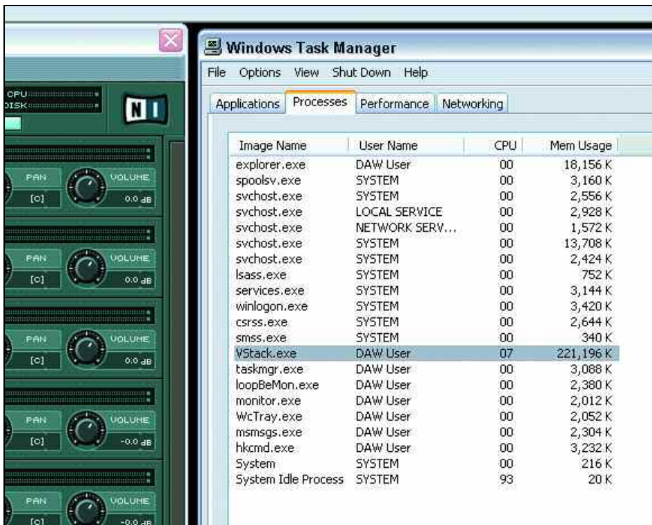
Рис. 5 и 6: Инстанция Kontakt 1 в хосте Steinberg V-Stack, и Диспетчер задач в Windows показывают сколько памяти использовано до и примерно через минуту после игры.
